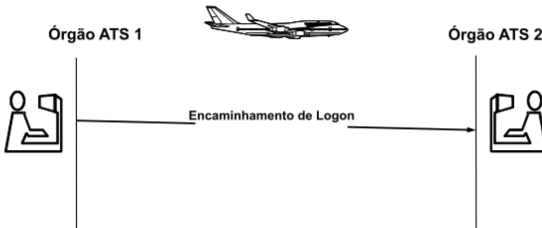
Figura 3 – Encaminhamento de endereço solo-solo utilizando a mensagem de encaminhamento de logon
