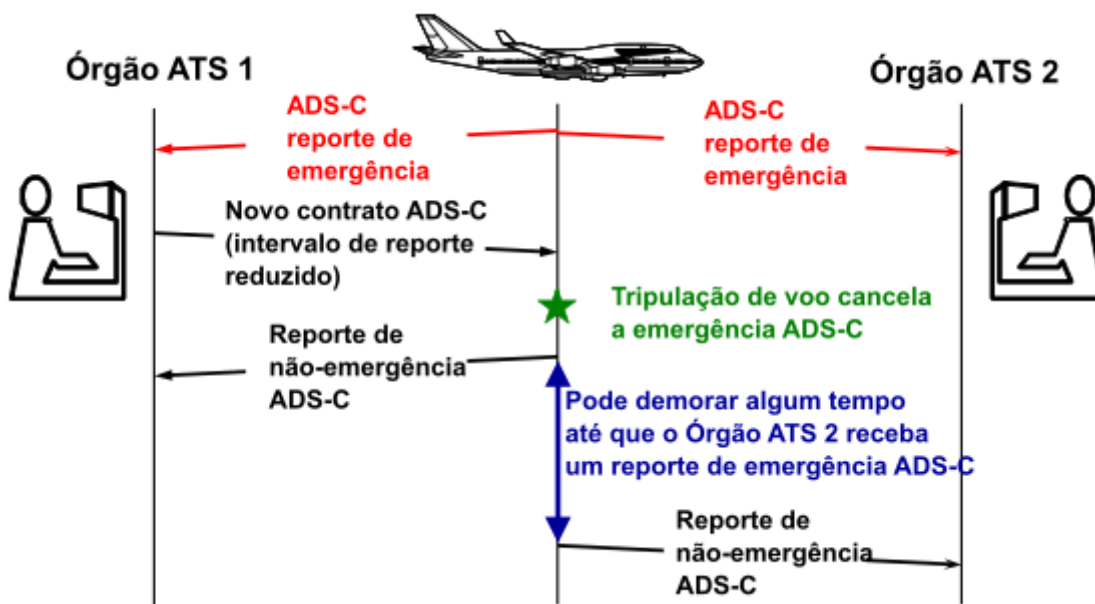
Figura 5 – Sequência de reporte de emergência ou não emergência ADS-C
